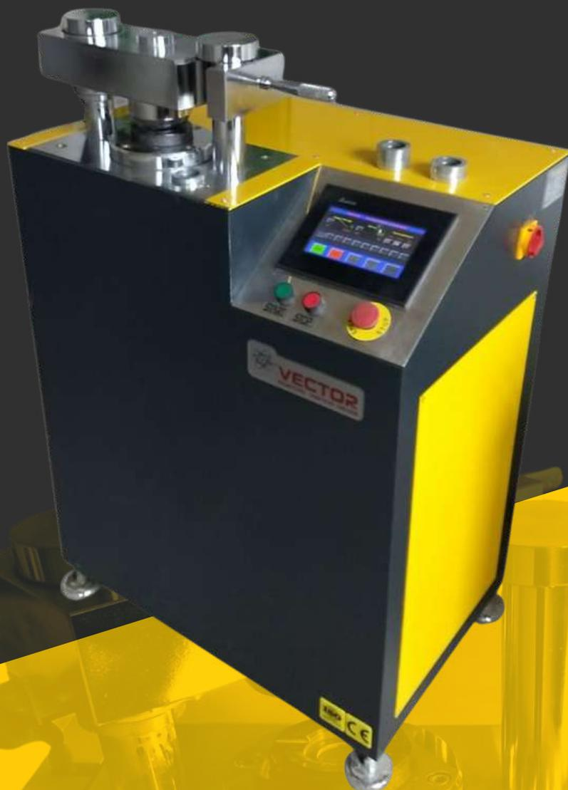
Гидравлический пеллетайзер с сенсорным экраном управления подходит для изготовления образцов гранул для XRF, IR и других аналитических методов.
