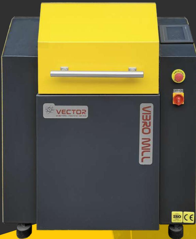
Специальная звукоизолированная безопасная кабина. Она используется в процессе измельчения хрупких материалов и минералов, таких как базальт, боксит, бетон, хром, ванадий, доломит, ферромарганец, феррованадий, гранит, уголь, кварц, силикат, известняк, шлак. Устройство предназначено для разрушения изделий размером 12-15 мм. Конечный размер конечного продукта 10-20 мкм. Для работы с размольными гарнитурами объемом 100, 250, 500 мл.
