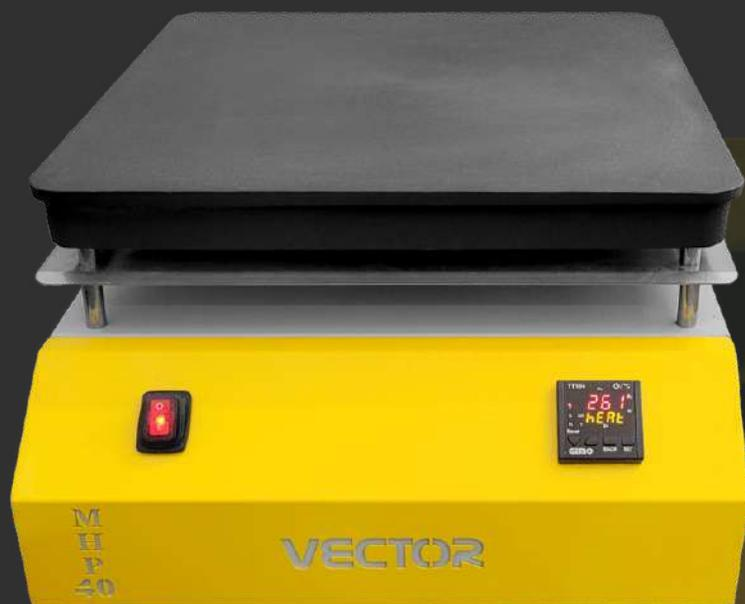
Нагревательная плита, которая является основным лабораторным устройством, предлагается нашей компанией в двух различных размерах для лабораторий текстильной, медицинской, пищевой, медицинской, химической и др. отраслей. Устройства используются в лабораториях для нагрева или кипячения жидкостей в емкостях при различных температурах от +10 °С до 300 °С.
